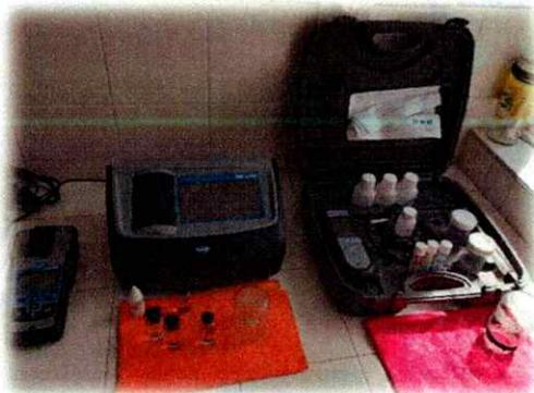
*Ilustración 21 Equipo para pruebas de jarras*
